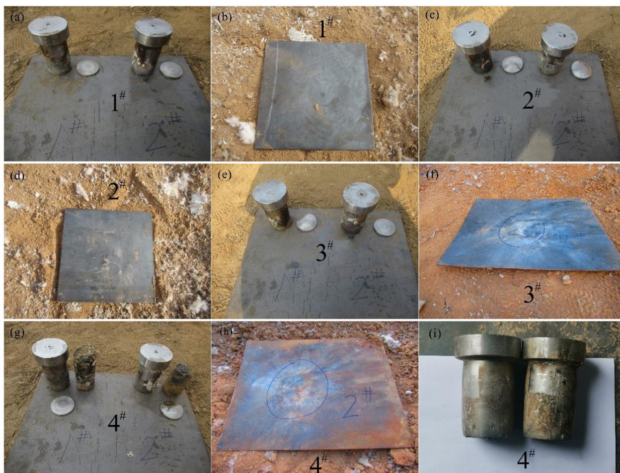
图6 样品1 # ~4 # 慢烤试验图(a, c, e, g为样品1 # ~4 # 烤燃弹图, b, d, f, h为样品1 # ~4 # 底部鉴证板图, i为样品4 # 弹壳状况图)
