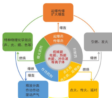
图1 火工药剂品种、能量转换及输出功能
