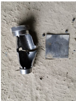
图8 IM发射药破片撞击试验结果
