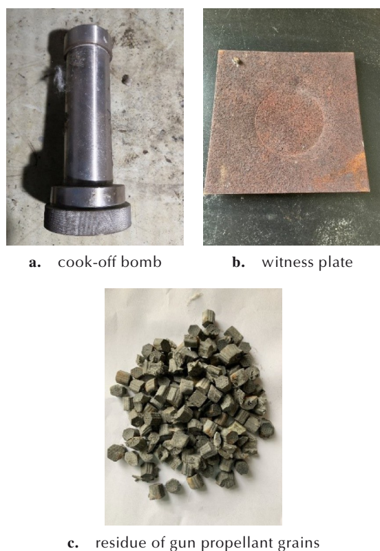
图4 IM发射药慢烤试验结果
