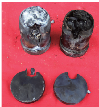
图6 GOXL 配方枪击试验后照片
