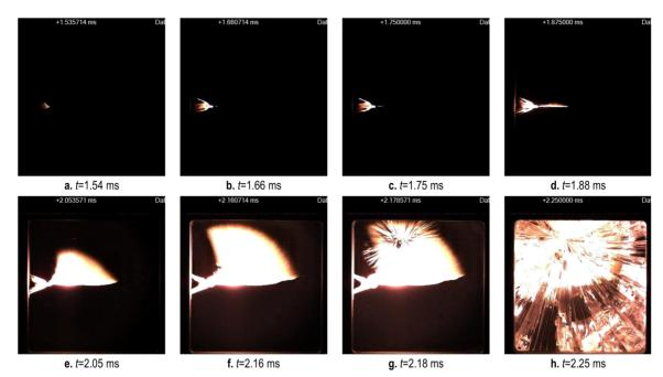
图3 实验1燃烧产物驱动裂纹扩展过程图像
