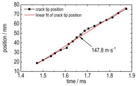
图6 实验2不同时刻裂纹尖端的位置和传播速度
