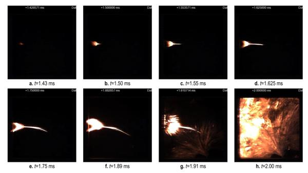
图 5 实验 2 燃烧产物驱动裂纹扩展过程图像
