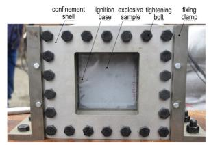
图1 炸药裂纹动态扩展实验装置图
