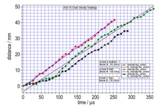
图7实验16裂纹扩展速度[14]
