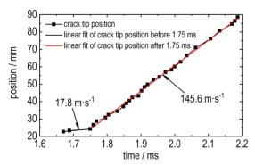
图 4 实验 1 不同时刻裂纹尖端的位置和传播速度
