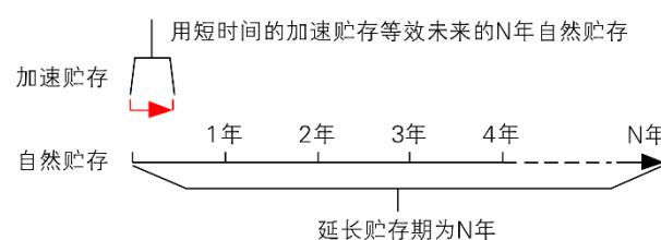
图7 加速贮存试验用途示意
