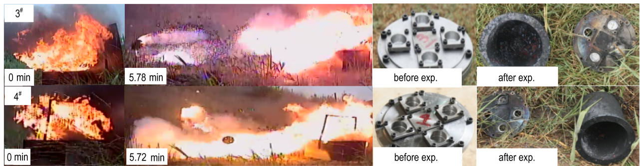
图4 3#和4#烤燃弹在不同时刻的快烤状态
