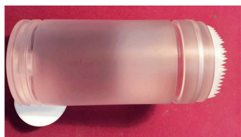
图3 带飞片的弹托
