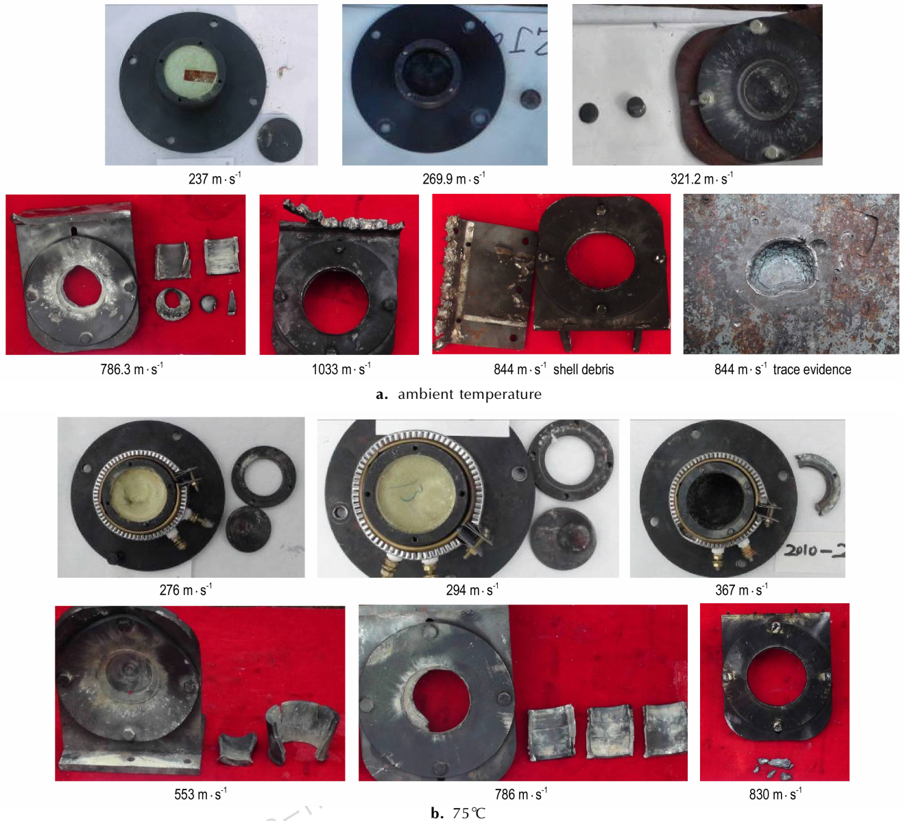
图7 回收的常温和 75 °C 时试验装置残骸照片
