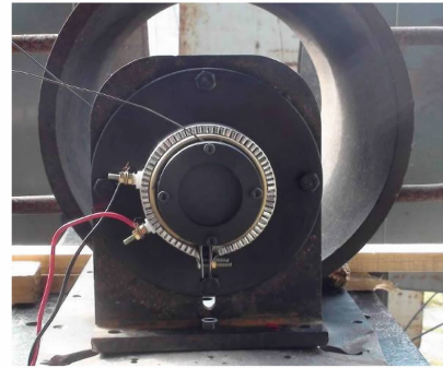
图3 PBX 炸药高温射弹撞击试验装置照片
