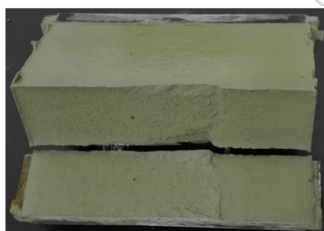
图 3 拉伸测试后的试件
