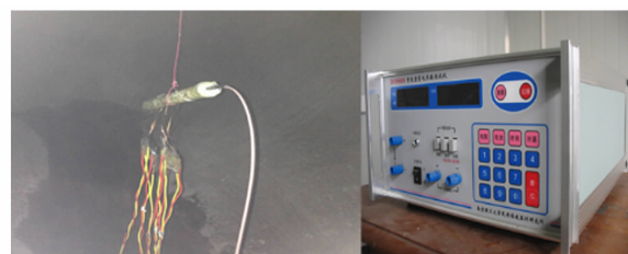
图 5 乳化炸药爆速测量实验
