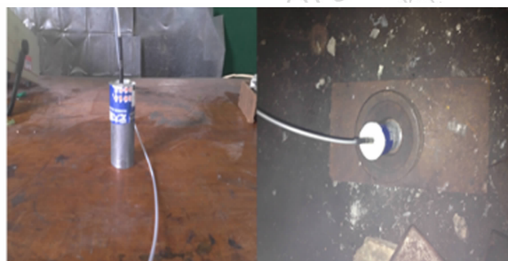
图 4 乳化炸药猛度测试实验
