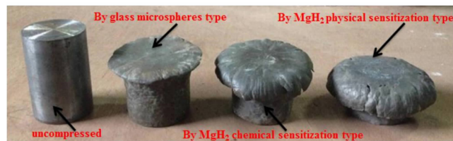
图 6 不同配方的乳化炸药铅柱压缩实验结果对比
