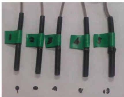
图 13 不同药量下收集到的管壳和飞片
