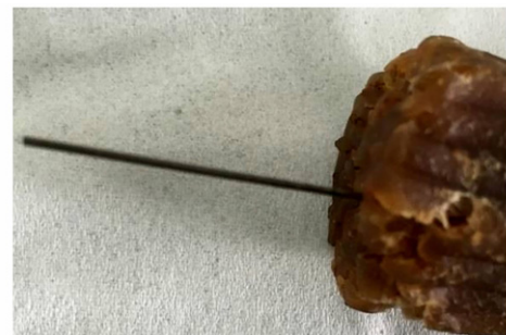
图 11 初始模具挤出 19 孔发射药
