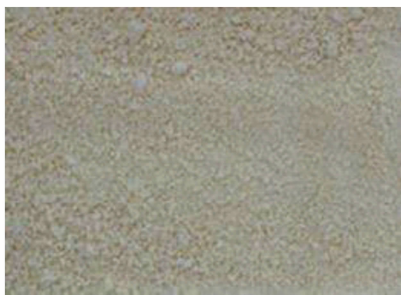
图1 EURENCO 制备的 NTO/TNT/RDX 造型粉颗粒
