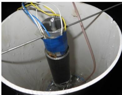
图 5 撞击压力测试试验装置
