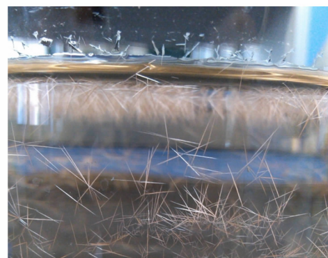
图 5 分离得到的针状 TNT 晶体
