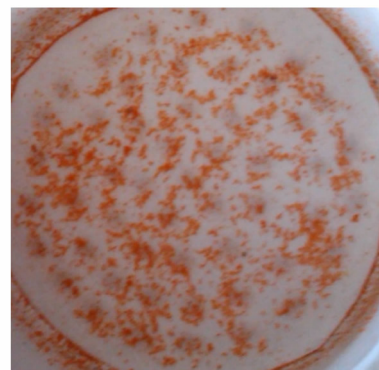
图 4 分离后得到黄色 TNT 固体
