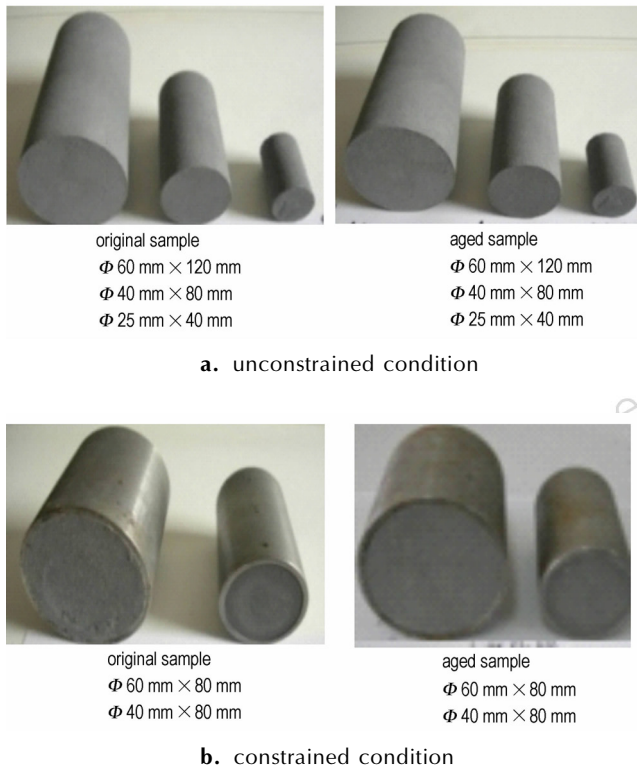
图2 PBX药柱原始及温度循环试验后外观
