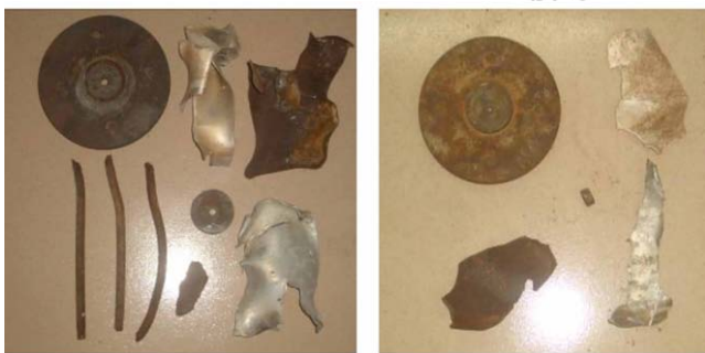
图3 升温速率对 GAP 推进剂慢速烤燃特性的影响
