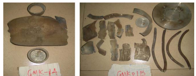
图5 约束条件对 GAP 推进剂慢速烤燃特性的影响
