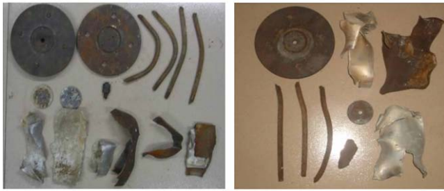
图2 燃速对 GAP 推进剂慢速烤燃特性的影响
