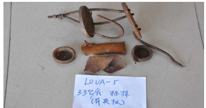
图4 约束条件对 HTPE 推进剂慢速烤燃特性的影响
