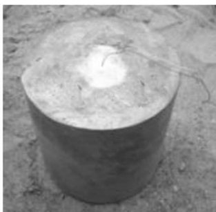
图 2 铅墙扩孔值试验示意图
