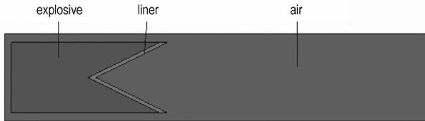
图3 整体结构几何模型
