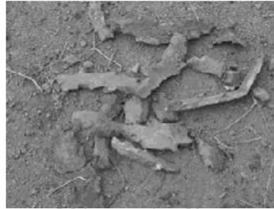
图 8 粒铸 CMDB 推进剂药粒 DDT 实验后钢管碎片 Fig. 8 Fragment after DDT test of the granule-cast CMDB propellant
