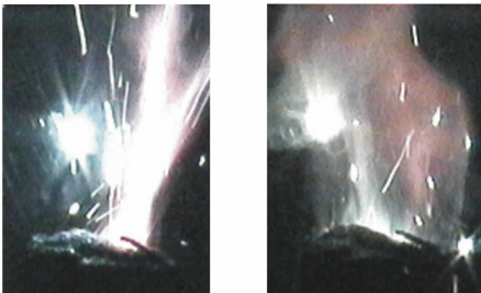
图 3 样品 C2 在 1.0\text{ MPa} 下不同时刻的 CCD 图像
