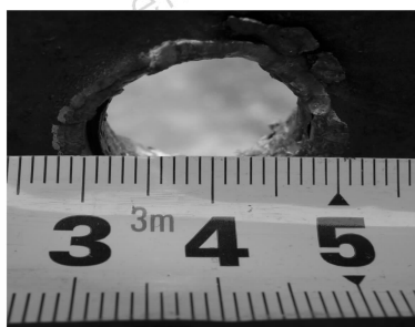
图3 复合反应破片对钢靶的穿孔照片
