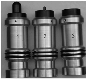
图 3 Steven 试验用不同形状弹头照片
