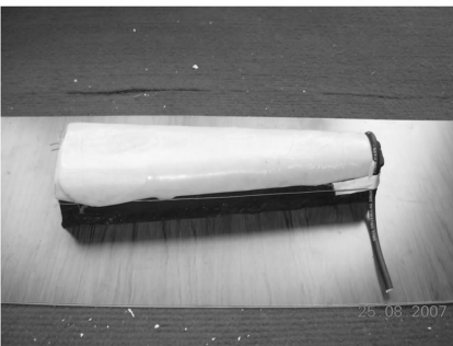
图4 经包覆压制成形后的敷设情况
