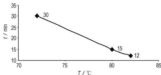
图3 安定性试验加热温度-时间曲线
