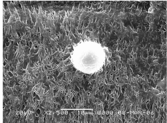
图4 PEG/N-100 弹性体拉伸后球晶形貌(×2500)
