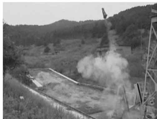
图2 模拟某型火箭座椅向上弹射试验
