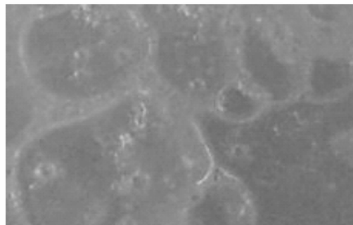
图 6 101 kPa、140 °C 下 ADN + 0.2% 石蜡熔化后的图片 Fig. 6 Photograph of melting ADN + 0.2% paraffin system under the conditions of 101 kPa and 140 °C
