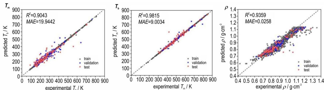
图 3 极限梯度提升回归模型预测不同烃类分子性质 ( $T_m$ 、 $T_b$ 、 $\rho$ ) 的预测值与实验值比较结果 (图中预测误差是模型在测试集上的误差)Fig. 3 Comparison of predicted and experimental values for different properties ( $T_m$ ,  $T_b$ ,  $\rho$ ) by XGBoost Regressor models (the prediction error in the figure is on the test set)
