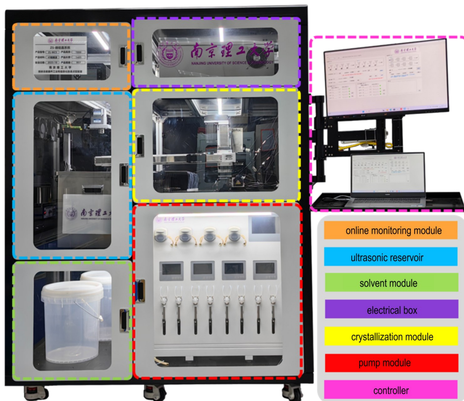
图5 ZS-1型微流控结晶系统
