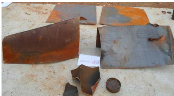
图7 中型试验件慢烤试验响应后照片
