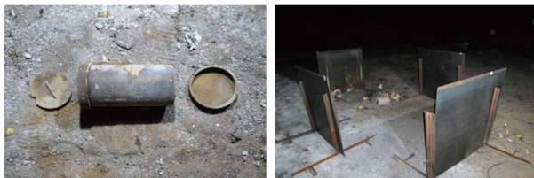
图6 小型试验件慢烤试验响应后照片
