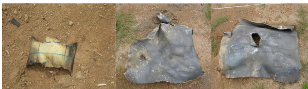
图8 大型试验件慢烤试验响应后见证板照片
