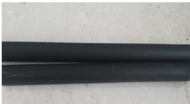
图 4 CL-20/GETPE 基高固含量推进剂药柱( \Phi 5\text{ mm} 、固含量 85%)
