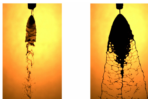
Fig. 6 a. v_{\text{jet}}=9.80 \text{ m} \cdot \text{s}^{-1} , d_0=0.5 \text{ mm} ; b. v_{\text{jet}}=10.49 \text{ m} \cdot \text{s}^{-1} , d_0=1.5 \text{ mm}
