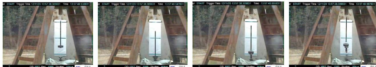
图 4 PBX-932 炸药压缩剪切试验典型高速录象照片 ( 28.7\text{ m} \cdot \text{s}^{-1} )
