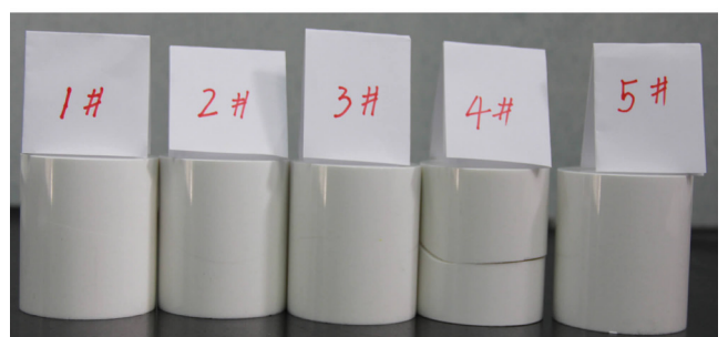
图 3 不同升温速率冲击下的 RDX 基 PBX 压制药柱
