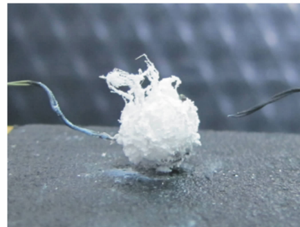
图6 水蒸气中镁颗粒燃烧剩余物 [20]
