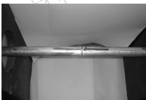
图 3 冲击前试样在 Hopkinson 杆上的初始状态
