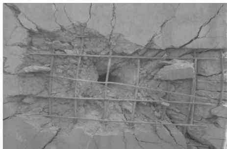
图 2 试验靶体正面破坏情况
