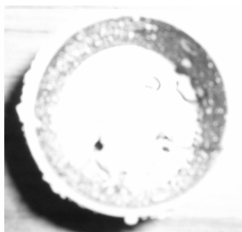
图1 实验后的陶瓷坩埚
