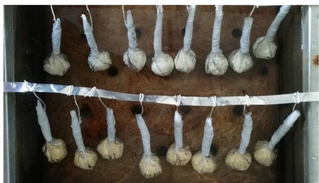
图 2 乳化炸药水浴加热老化实验
