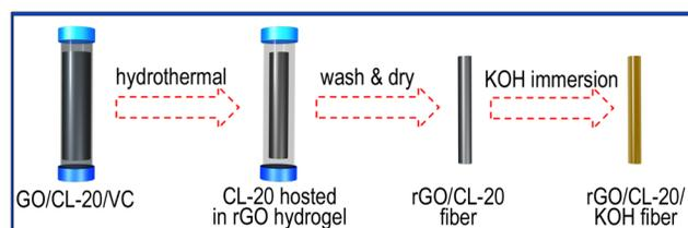
图1 维度限制水热法制备rGO/CL-20自支撑纤维的过程示意图
