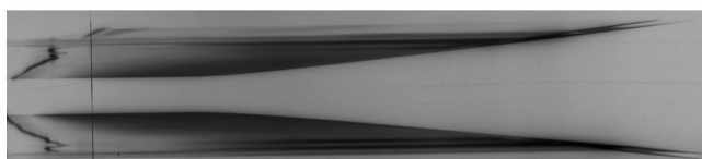
图 7 圆筒壁膨胀的扫描照片
