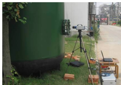
图 1 水下爆炸实验光测系统
