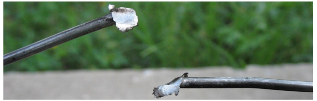
图 5 金属爆炸索未发生径向爆轰
