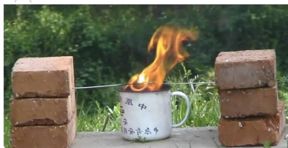
图 3 金属爆炸索的无基板燃烧实验
