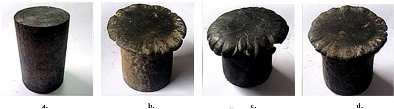
图 5 不同敏化方式的乳化炸药铅柱压缩对比实验
