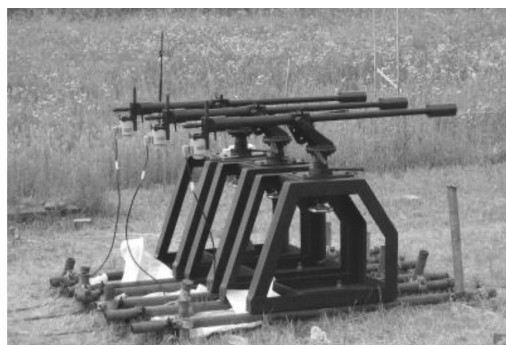
图 2 12.7 mm 子弹撞击试验装置
