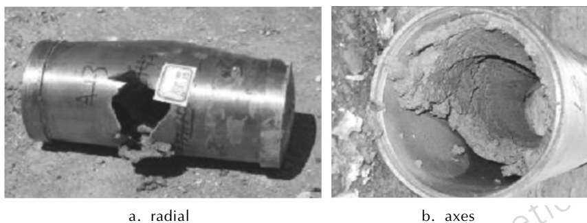
图 7 12.7 mm 子弹撞击试验结果
