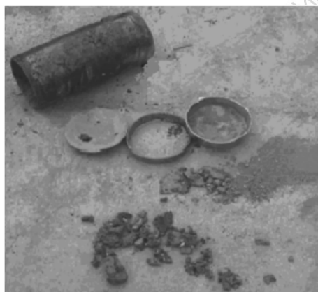
图 9 慢速烤燃试验后的试样状态
