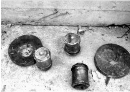
图3 碰靶后的射弹后座及验证靶板
