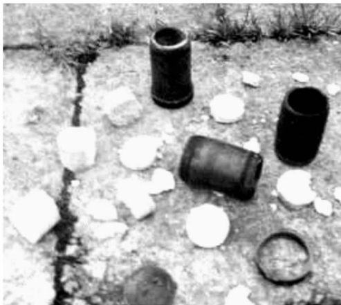
图4 试验后的炸药装药
