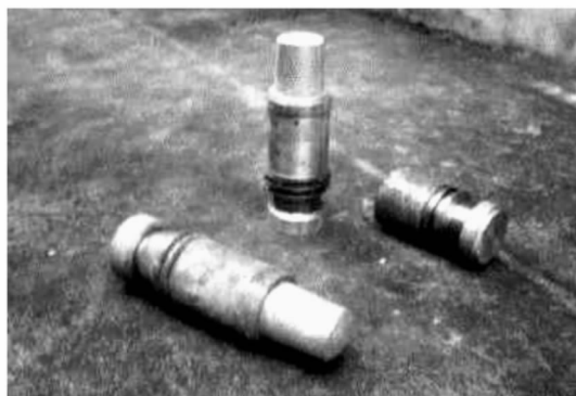
图 2 射弹弹丸(头部铝帽或小端中为炸药装药)
